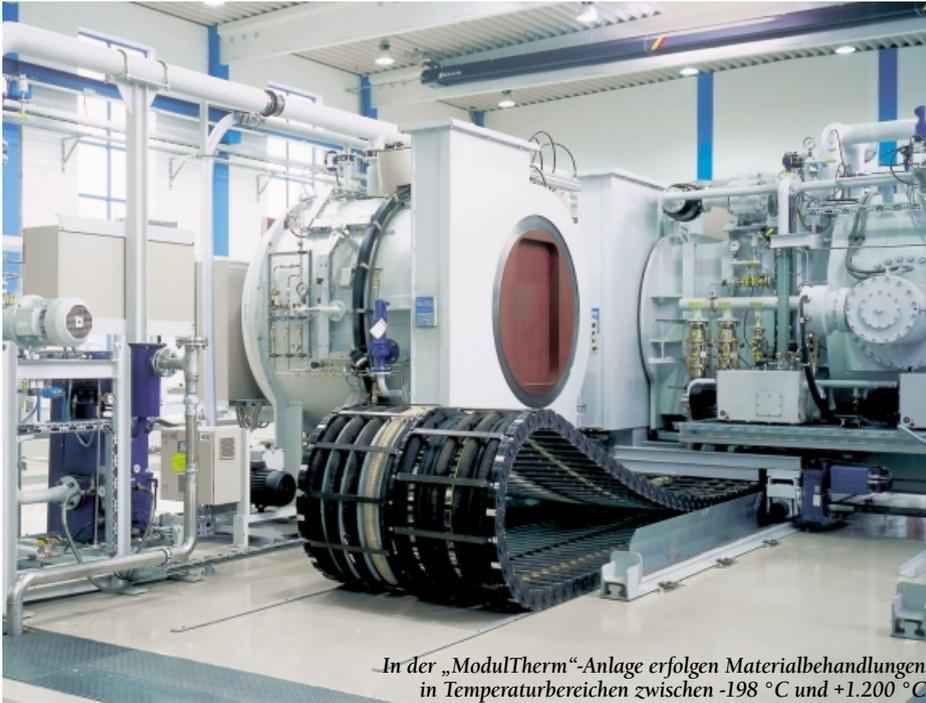
In der „ModulTherm“-Anlage erfolgen Materialbehandlungen in Temperaturbereichen zwischen -198 °C und +1.200 °C
