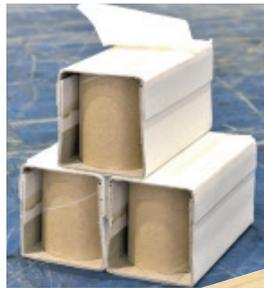
**Bild links:** Durchgeschnittene Muster der „squAIR-timber®“-Verstrebungen mit den innen liegenden Rundhülsen
