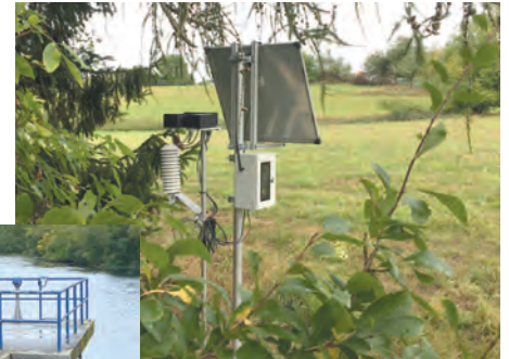
Bilder oben und links: Innovative Sensortechnik von dimeto erhebt u.a. Umweltdaten, wie Regen und Hagel, oder hilft bei der Messung von Pegelständen bei Gewässern.
